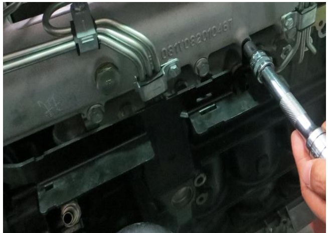
图 2-378：拧紧线束支架固定螺栓
