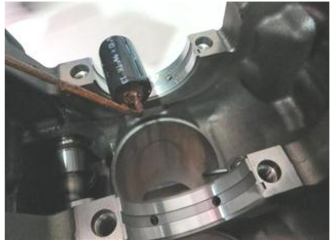
图 2-22：主轴上瓦涂机油
