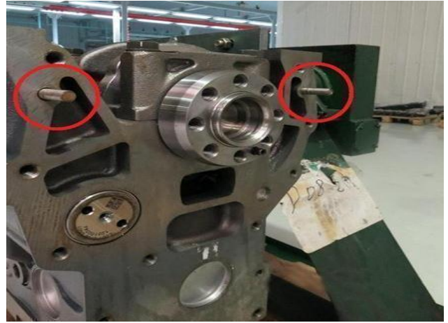
图 2-51：安装完成后的飞轮壳定位
