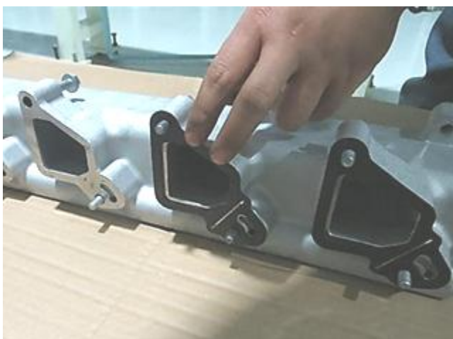
图2-200：密封垫与进气管一起装上气缸盖
