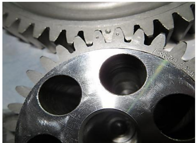
图 2-99: 齿轮圆点标记
