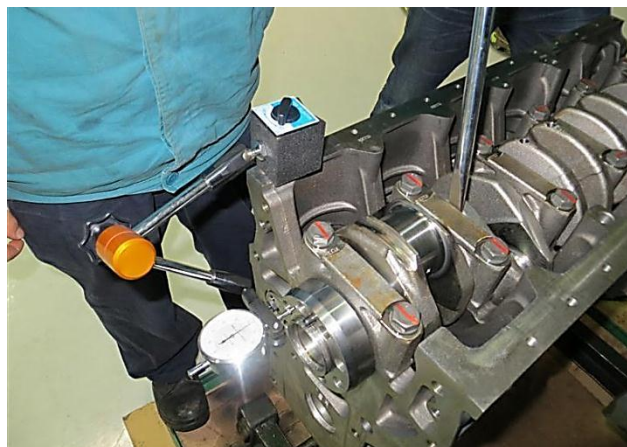
图 2-42：测量曲轴轴向间隙
