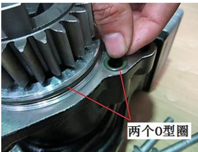
图2-258：安装两个O型圈
