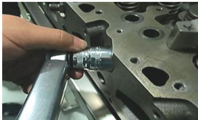
图2-173：拧紧压紧块固定螺栓及高压管接头
