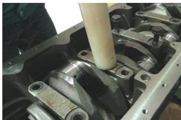
图 2-36: 使主轴承盖落座
