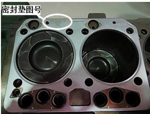
图 2-179：气缸盖密封垫安装示意图
