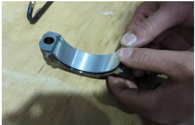
图 2-74：对准卡瓦槽安装连杆瓦
