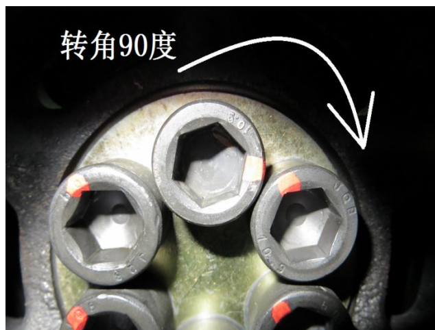
图 2-119: 减震器螺栓转角拧紧
