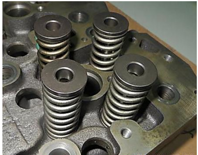
图2-163：放上气门弹簧与气门上座
