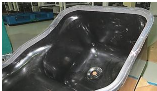
图2-134：油底壳上安装橡胶密封圈
