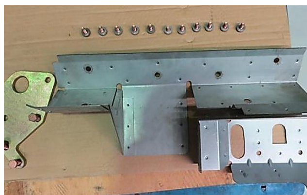
图2-240：排气管隔热罩及吊耳
