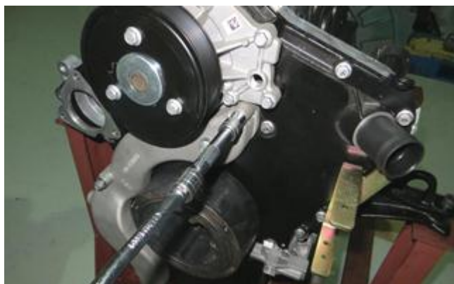
图 2-144：紧固冷却液弯管
