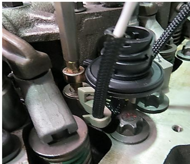
图2-196：线束插座固定上气缸盖
