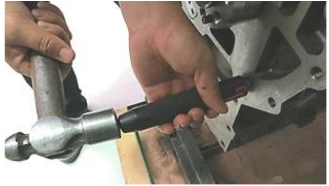
图 2-45：前后端面安装主油道碗型塞
