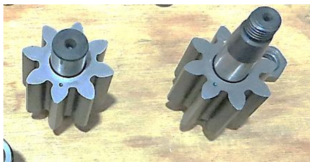
图 2-84: 机油泵齿轮组件
