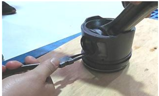
图 2-71：安装活塞销挡圈
