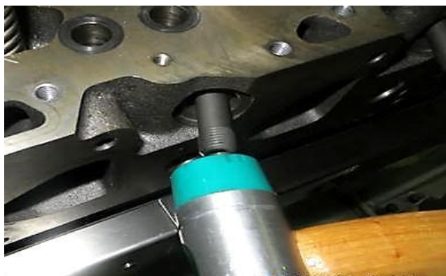
图2-171：用安装锤轻敲保证安装到位
