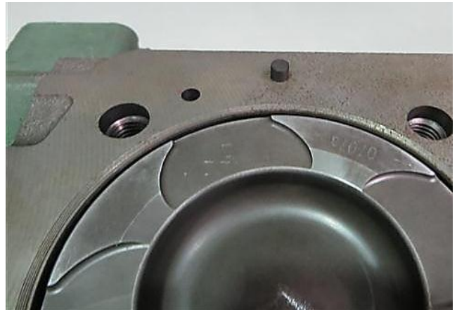
图 2-177: 已安装到位的定位销
