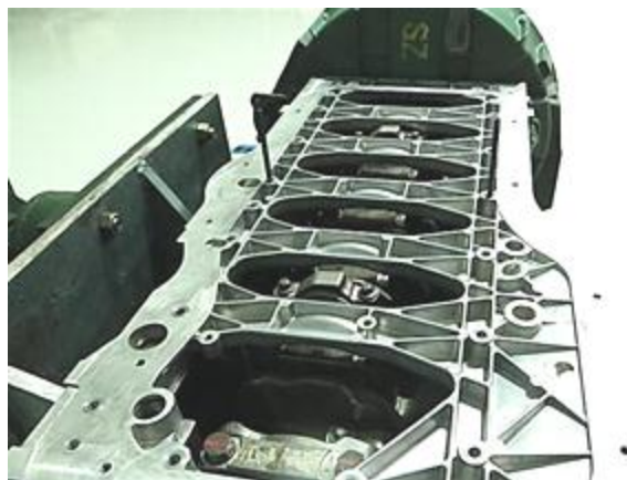
图2-127：沿导向杆装上曲轴箱过渡板
