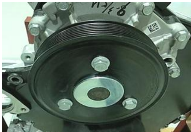
图 2-142：水泵皮带轮安装
