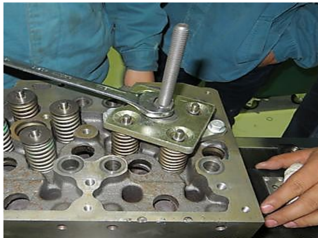
图2-164：安装气门锁夹
