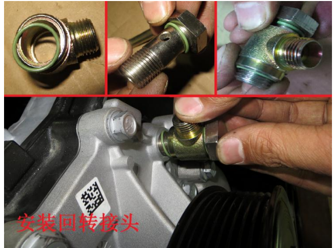
图 2-346：安装回转接头
