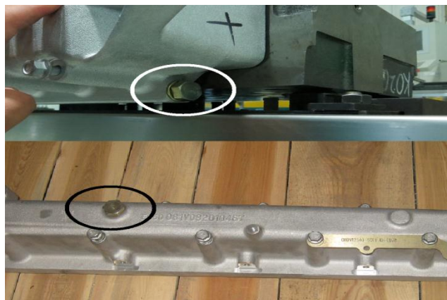
图2-199：喷油器燃油回油工艺堵头
