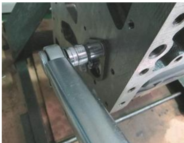
图 2-14：安装凸轮轴法兰
