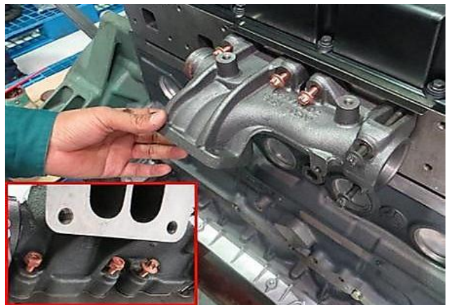
图2-221：装上3-4缸排气管
