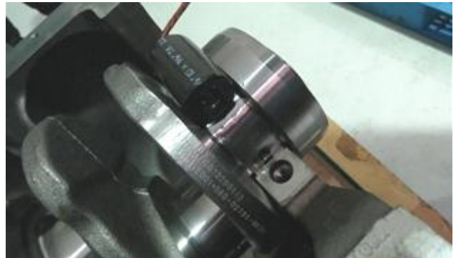
图 2-33: 主轴颈刷机油
