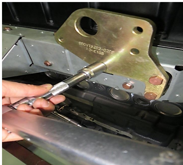
图2-242：吊耳安装位置
