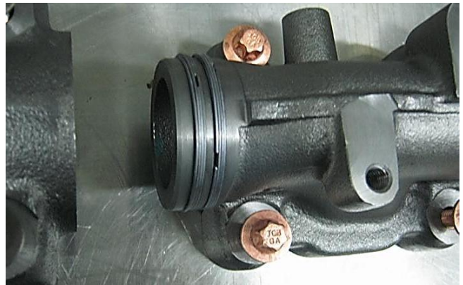
图2-216：将密封环开口错开
