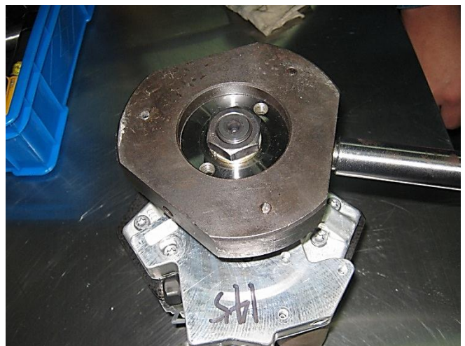
图 2-152：固定齿轮后拧紧螺母
