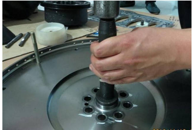
图 2-60：安装飞轮轴承
