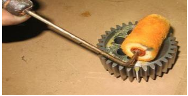
图 2-94: 曲轴分油齿轮涂胶
