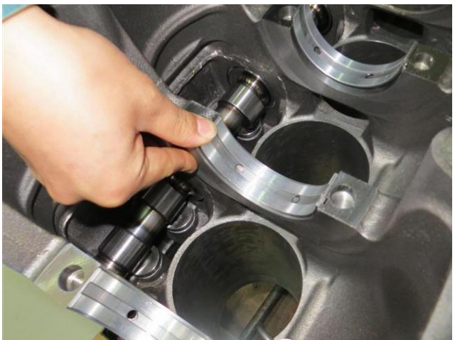
图 2-20: 安装主轴上瓦
