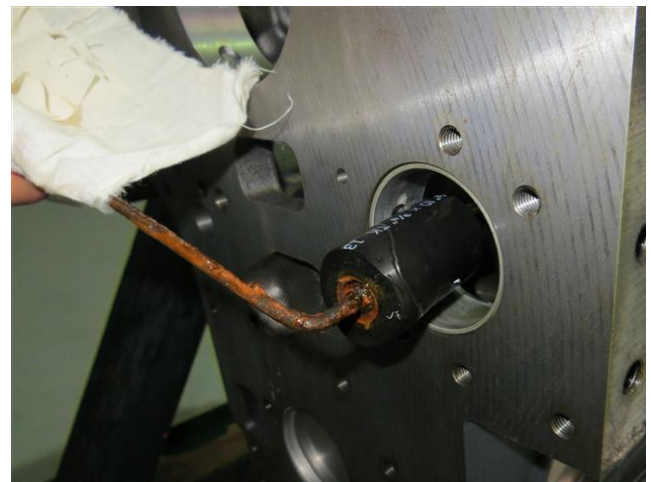
图 2-10：凸轮轴衬套上油
