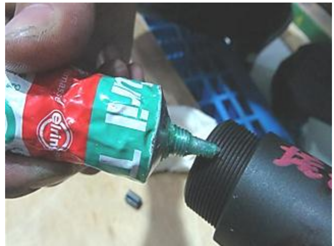
图 2-113：加油短管涂胶
