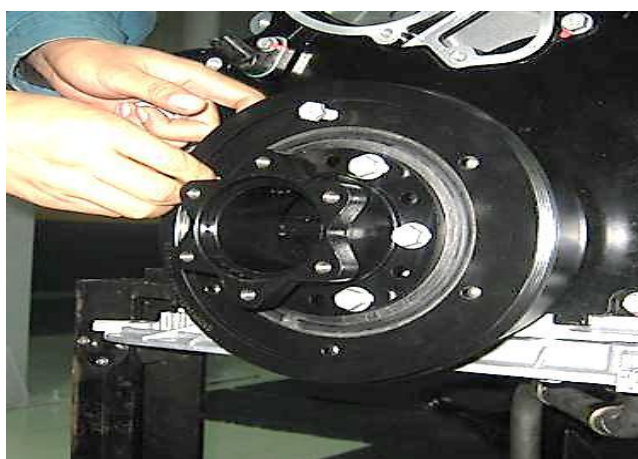
图 2-120: 安装曲轴皮带轮、风扇法兰
