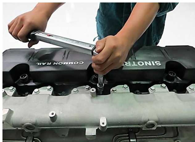
图 2-212：安装摇臂罩壳
