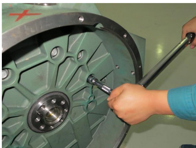
图 2-58：对角交叉拧紧飞轮壳螺栓
