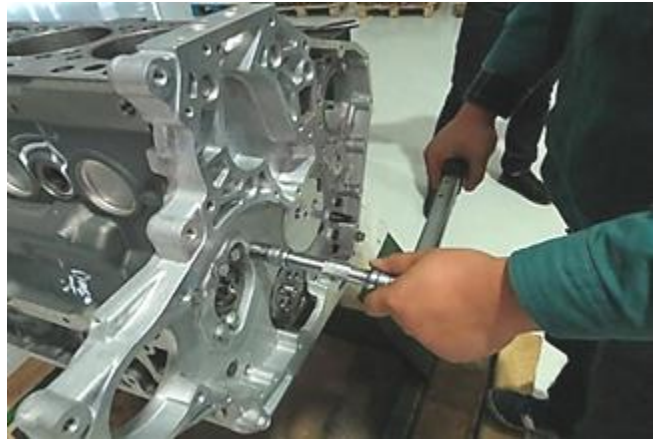
图 2-90：按拧紧顺序拧紧固定螺栓
