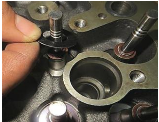
图2-162：安装气门下座
