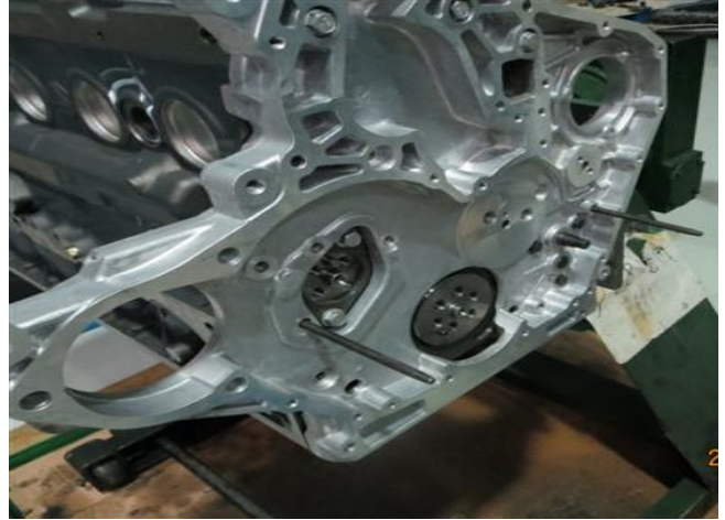
图 2-89：安装上齿轮室
