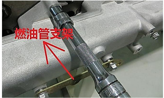
图2-202：燃油管支架安装位置示意图
