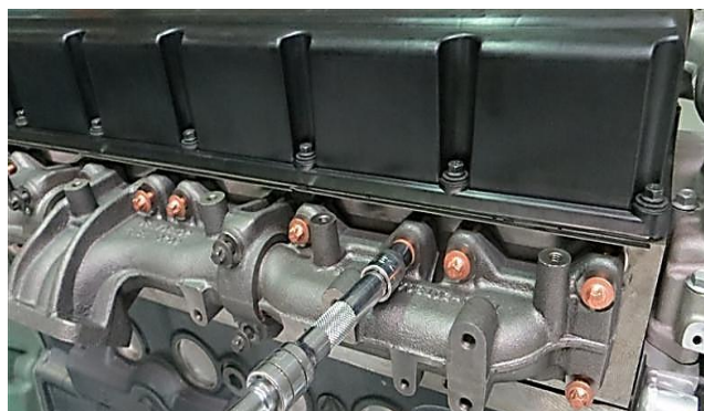
图2-223：按顺序拧紧各排气管固定螺栓
