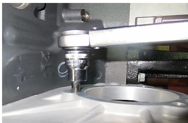
图 2-154: 在喷油泵安装面上拧紧螺栓
