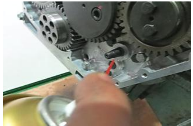
图 2-101：清洗齿轮轴锥面
