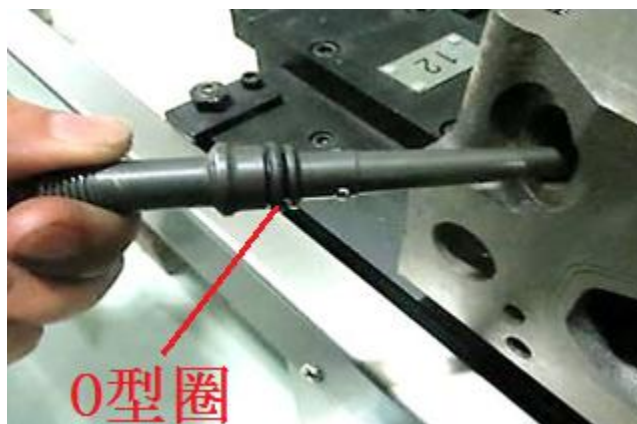
图2-170：手工装入高压接管
