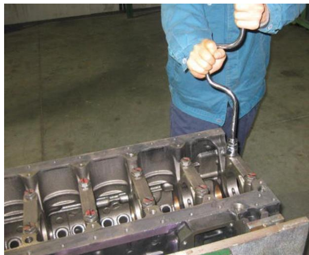
图 2-02: 松主轴承盖螺栓
