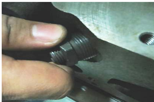
图2-172：拧上螺纹压力管接头
